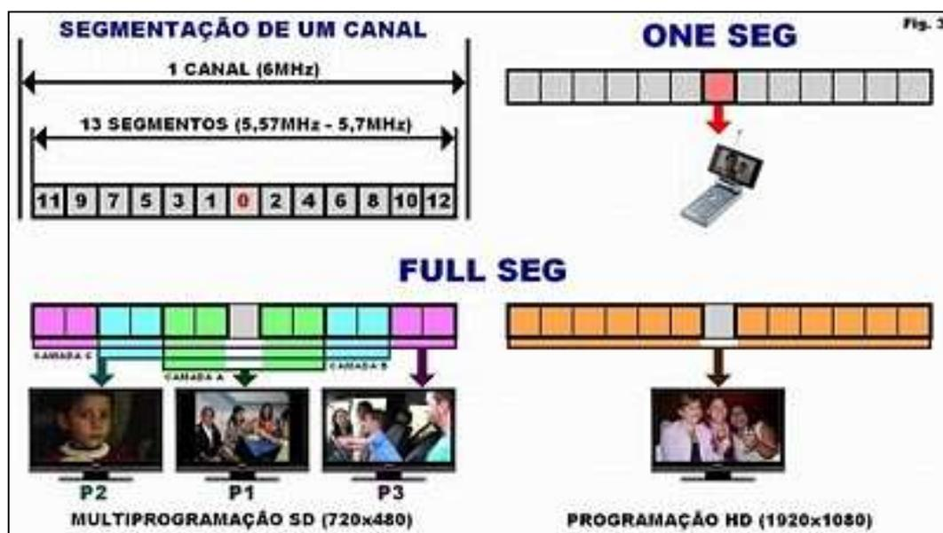
Figura 1 Possibilidade de uso do espectro de frequência e sua divisão em 13 segmentos.
